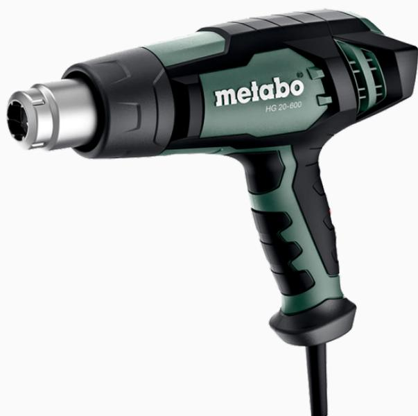
Pistola de aire caliente profesional de 2000 W. Con temperatura regulable entre 50/600 C°. Amplia gama de aplicaciones: remoción de pintura, modelado, contracción, soldadura y mucho más, Calentador de cerámica de alta calidad, motor potente y refrigeración óptima del aparato para una larga vida útil, Manejo cómodo gracias al diseño ergonómico y la empuñadura con superficie Softgrip antideslizante, Trabajo estacionario seguro gracias a la amplia superficie de colocación antideslizante.
