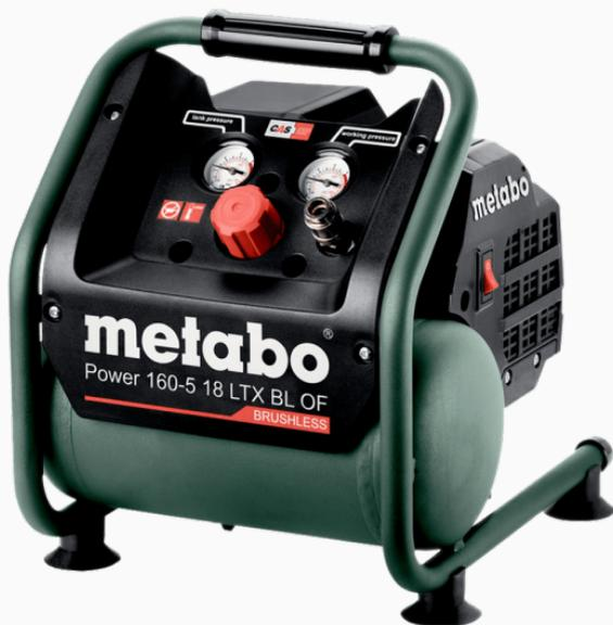
Compresor a batería de 18v, liviano y potente con motor sin carbones para el uso profesional en interiores y en obras. este compresor de émbolo sin aceite, es muy fácil de transportar y con un bajo costo de mantenimiento. Panel de instrumentos con manómetros de fácil lectura para la presión de la caldera y de servicio. Presión de trabajo regulable, de fácil manejo por manorreductor con manómetro. Grifería y elementos de mando protegidos y bien visibles en el marco tubular.
