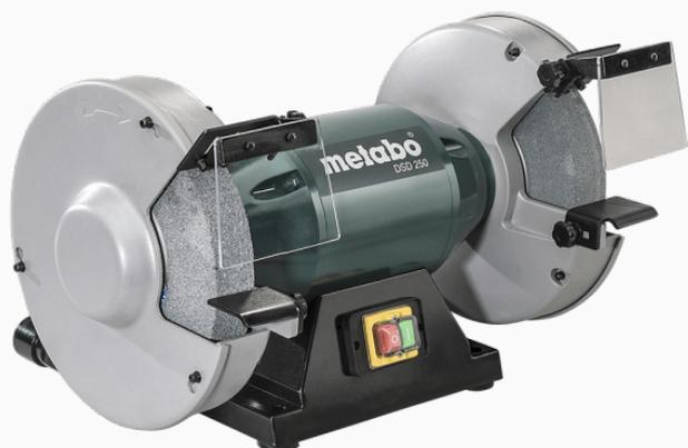
Esmeril doble combinado, para trabajos de desbaste, afilado y lijado, con motor de inducción sin vibraciones y silencioso (500 W/2980 rpm). Diámetro de piedra esmeril 175x25x32 mm. Con seguro contra arranque involuntario. Cubierta con cierre de bayoneta para un rápido cambio de piedras esmeriles. Cristales protectores contra chispas de gran dimensión. Conexión para aspiración en ambos lados Ø35 mm.
