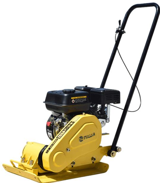
Esta plancha compactadora de 60 kg con el eficiente y confiable motor Robin de 5,0 HP, es ideal para trabajos pequeños de compactación hasta 0,20 m de espesor de suelo. De 0,36 m de ancho, puede utilizarse para compactar encadenados o cimentaciones corridas.
