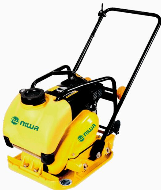
Esta plancha compactadora con tanque de agua, de 97 kg y 6,5 HP , es muy utilizada para trabajos de bacheo en pavimentos de asfalto, así como para trabajos de compactación hasta 0,30 m de espesor de suelo. Puede usarse en zanjas de 0,50 m de ancho.
