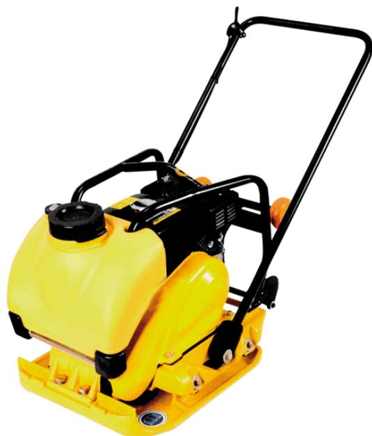
El motor Robin de 5,0 HP hace de esta plancha compactadora con tanque de agua de 97 kg una excelente opción para trabajos de bacheo en pavimentos de asfalto, así como para trabajos de compactación hasta 0,30 m de espesor de suelo. Puede usarse en zanjas de 0,50 m de ancho.
