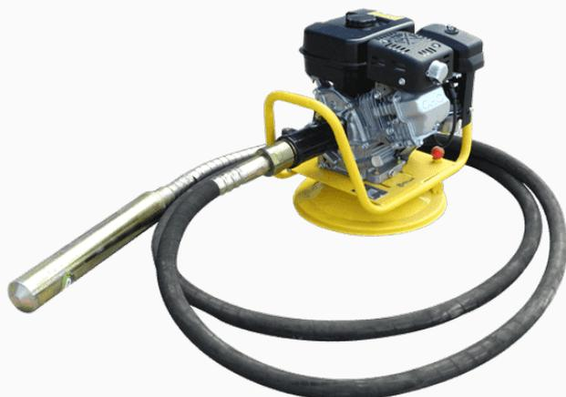
Esta unidad motriz de 5,5 HP y 3000 RPM para vibradores de inmersión, es la que ofrece la mejor relación costo/prestaciones. Tiene conexión Dynapac apta para cabezales de 38/ 45 / 50 / 70 mm, así como también para las bombas sumergibles Niwa.
