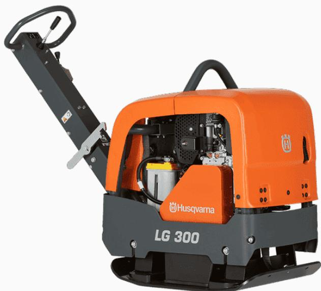
La LG 300 es una Plancha compactadora reversible de 265 kg , diferente a todo lo que hay en el mercado. Potente y compacta, tiene un rendimiento de 750 m<sup>2</sup>/hora. Es la máquina ideal para suelos granulares como arena y grava de poco espesor, si busca un producto que responda y sea fácil de manejar.
