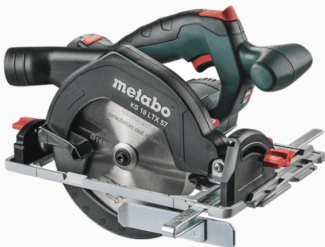
Sierra circular a Batería 18 V, para uso universal en obras. Placa base se aluminio. Freno de marcha de inercia. Cortes diagonales en ángulos de hasta 50° con encastre de 45°. Indicador de corte visible. Empuñadura antideslizante. Conexión de aspirador universal
