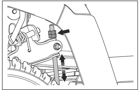
**Nota:** Los tirantes de la altura de corte se encuentran detrás del equipo de corte, delante de las ruedas traseras.
