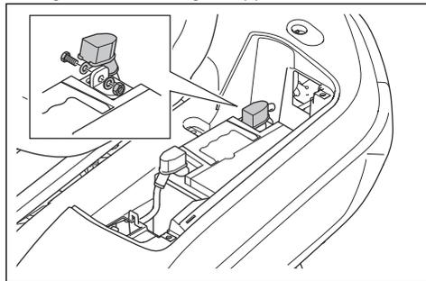
5. Retire la cubierta del terminal del cable rojo de la batería.
