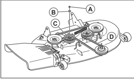
4. Retire la correa del equipo de corte (D) de las poleas de las cuchillas del equipo de corte.
