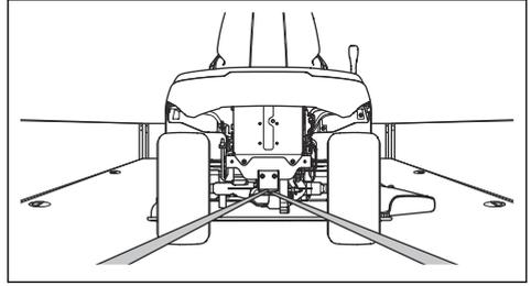
6. Tense la correa tirando hacia atrás para sujetar el producto en el área de carga.
