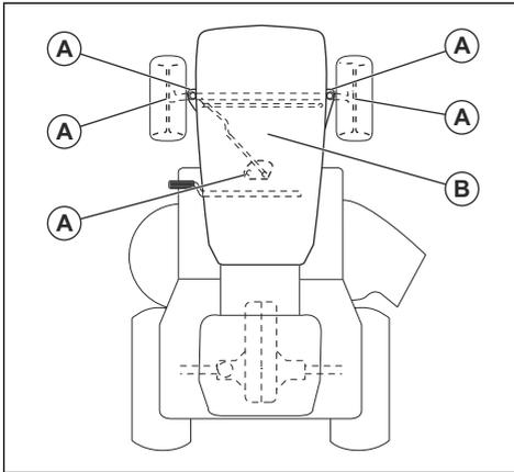
A. Lubricación general. Lubrique la conexión de engrase del eje y los dientes del engranaje del sector y la columna de dirección.
