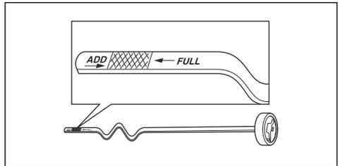
8. Reponga el aceite a través del orificio de la varilla de nivel. Añada el aceite lentamente.
