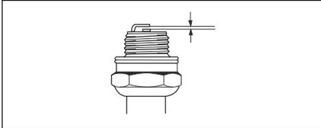
6. Doble el electrodo lateral para ajustar la distancia entre los electrodos.
