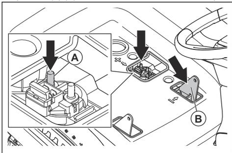
2. Conecte el cable de carga negativo (-) al punto de conexión negativo (-) (B).
