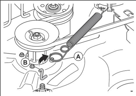
6. Retire la correa del equipo de corte de la polea del motor.
