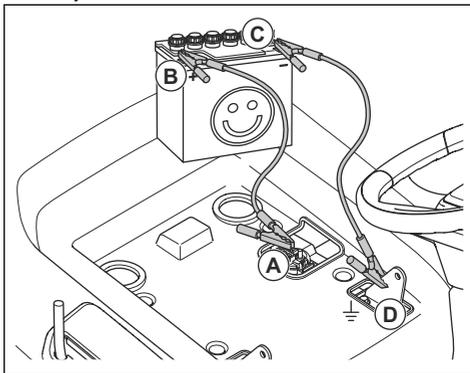
2. Conecte el otro extremo del cable rojo de la batería al terminal POSITIVO (+) (B) de la batería cargada.
