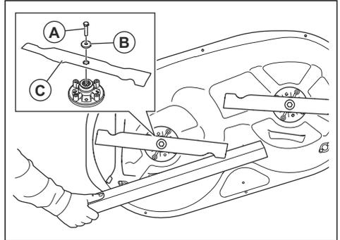
3. Retire el tornillo (A), la arandela (B) y la cuchilla (C).
