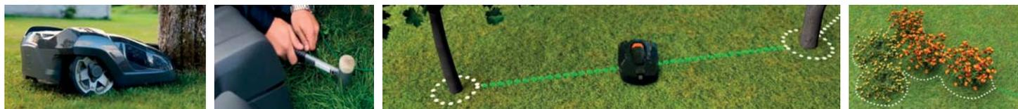
Si el terreno tiene zonas remotas con pasos estrechos, pueden instalarse guías para ayudar al robot a atravesar dichos pasos.
